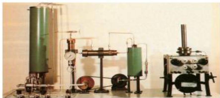
图 7-5 哈伯发明的合成氨实验装置
